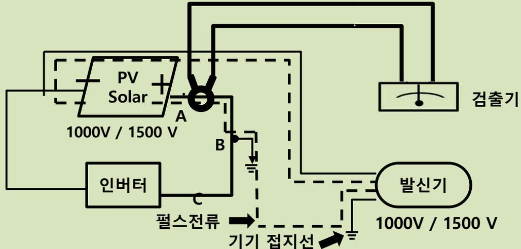
(+)선로의 B점에 접지가 발생시에 펄스전류 발신기의 PV 선로를 소내 인버터 (-)모선에 연결하고, 다른 선은 구내 접지선에 연결하면 펄스전류 발신기에서 발생된 펄스전류가 PV(+) $\rightarrow$ A $\rightarrow$ B $\rightarrow$ 대지 $\rightarrow$ 발신기 접지선 $\rightarrow$ PV(-)회로로 흘러 검출용 CT로 직류선로를 따라 이동해 가면서 탐색하면 접지구간에서만 펄스전류가 감지되어 접지점(B)를 검출할 수 있음.
