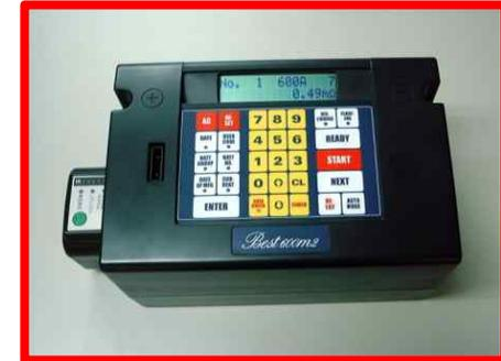
1. 축전지 설치 후 초기 방전시험 또는 단 셀 방전시험을 통하여 제조 불량 셀을 1차로 판별하시기를 권고합니다.
